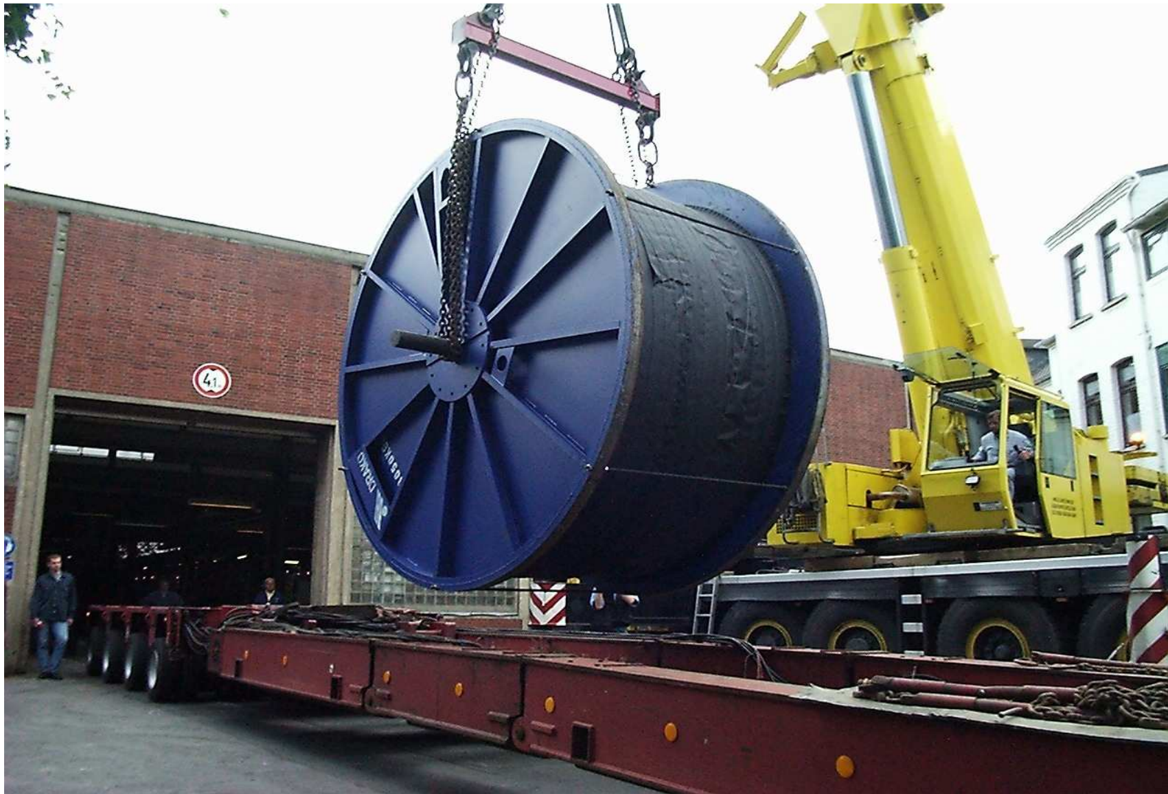
Verladung von Flachunterseilen (Gewicht der Trommel 34 to)
